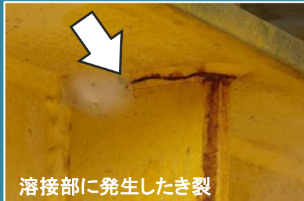
き裂が進展し破断に至った例
