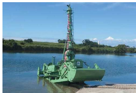
写真-2 D155W-1型水陸両用ブルドーザ
