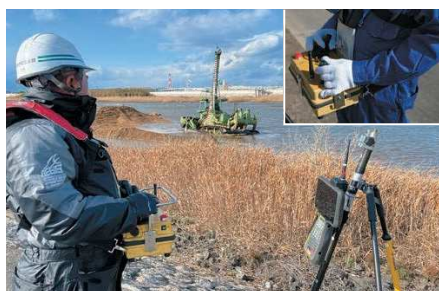
写真-6 オペレータは機械に搭乗せずに無線遠隔操縦
