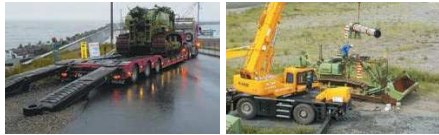
図-6 左:低床トレーラ等で運搬 右:組立・分解にはラフテレーンクレーンを用いる
