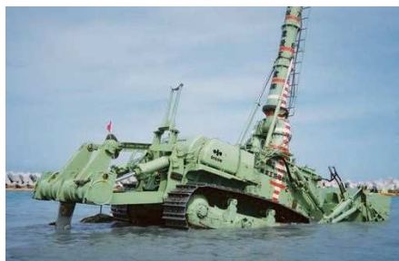
写真-5 油圧リッパ装置
