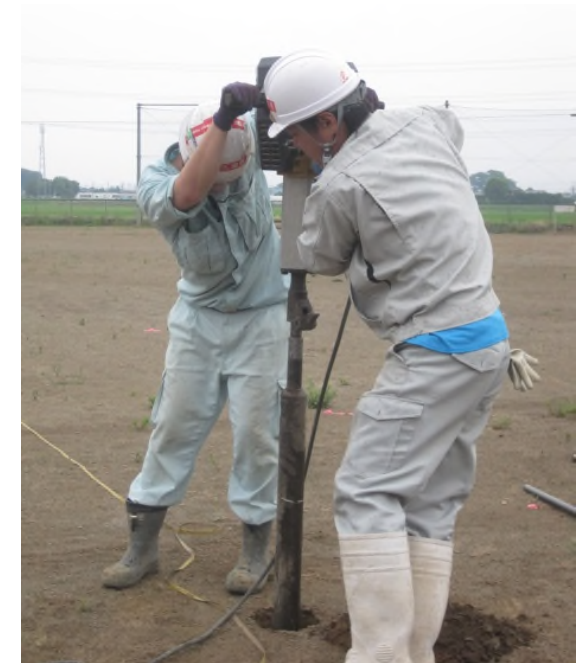
簡易ボーリング（振動式サンプラー）による土試料の採取
