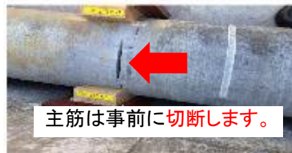
写真2: 試験前 系感測の縦筋切筋
