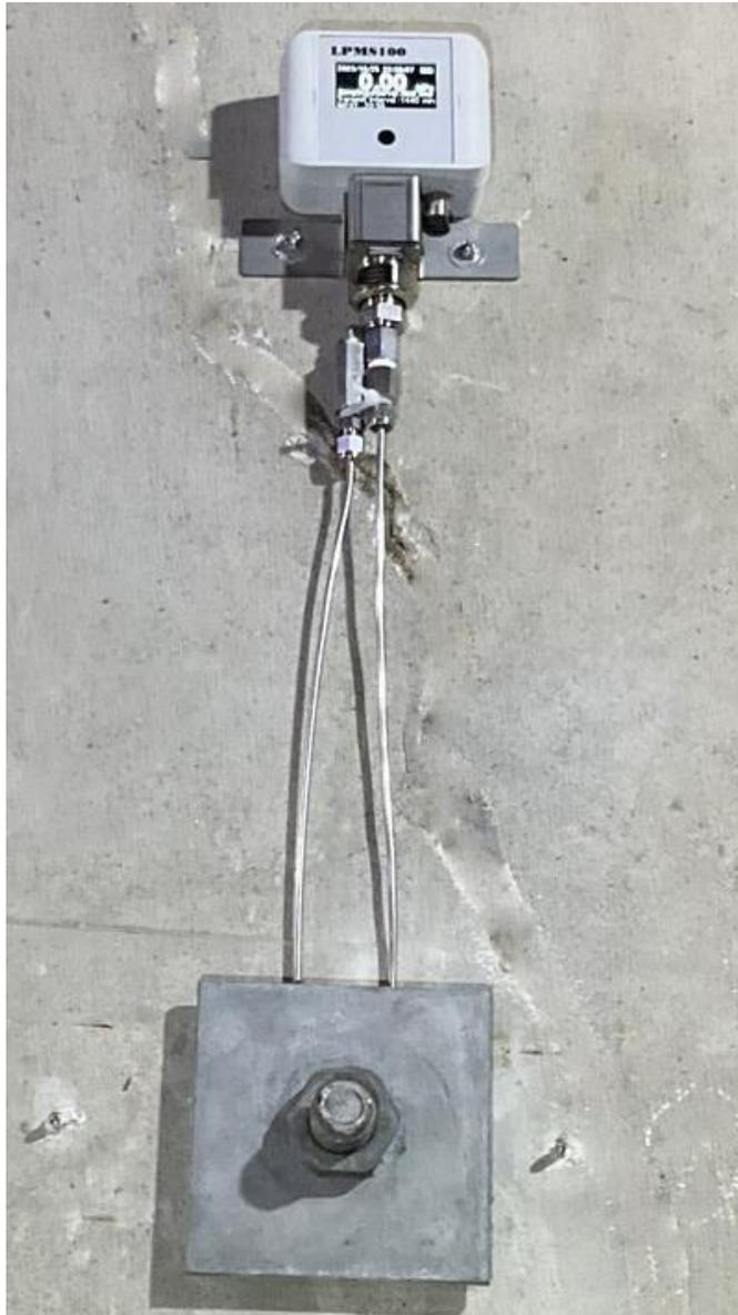
ロックボルト軸力計の「補助的な計測器」として使用し、ロックボルトのプレートにかかる荷重を計測することにより、設置本数の評価や頭部にかかる荷重の確認が可能となり、ロックボルトによる変状部補強対策施工後の監視を行うのに効果的な製品です。
