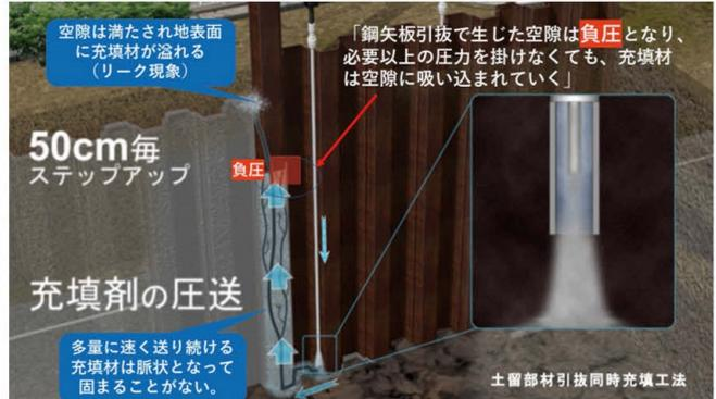
GEOTETS (ジオテツ) 工法
