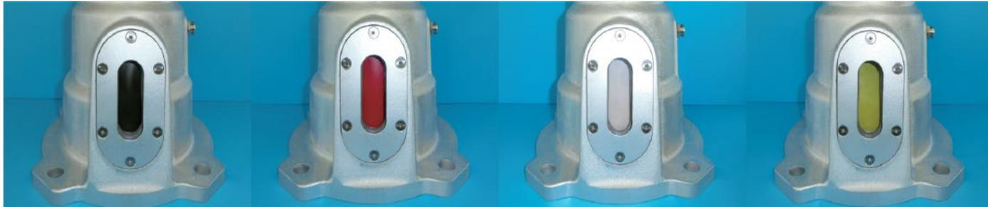
目視管理型ヘッドキャップ内の防錆材色相変化確認
