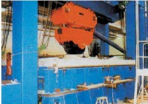
旧建設省土木研究所(現)土木研究センター、民間15社による共同研究「道橋橋床版の輪荷重走行試験設備における疲労耐久性評価手法の開発」(平成11年10月)より
