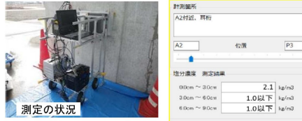
測定結果の例 (コンクリート表面からの塩分濃度を検知)
