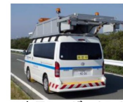
3次元レーザーセンサ を用いた舗装損傷検知
