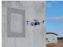
ドローンによる損傷把握
