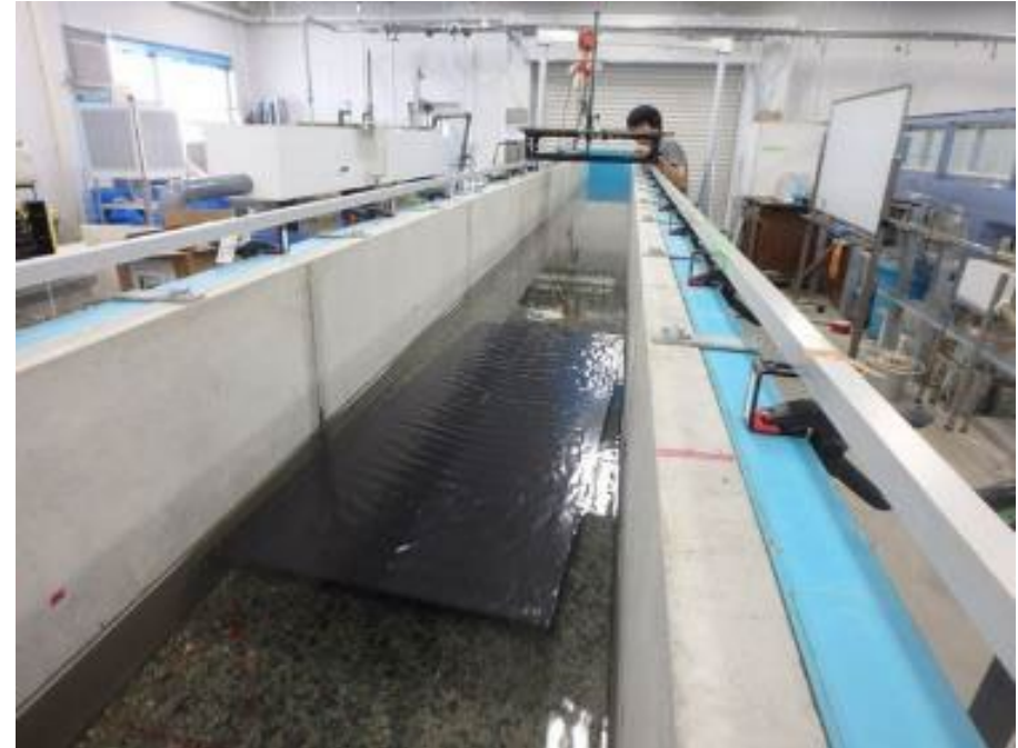
レーザー距離計を用いて非接触での水位計測
