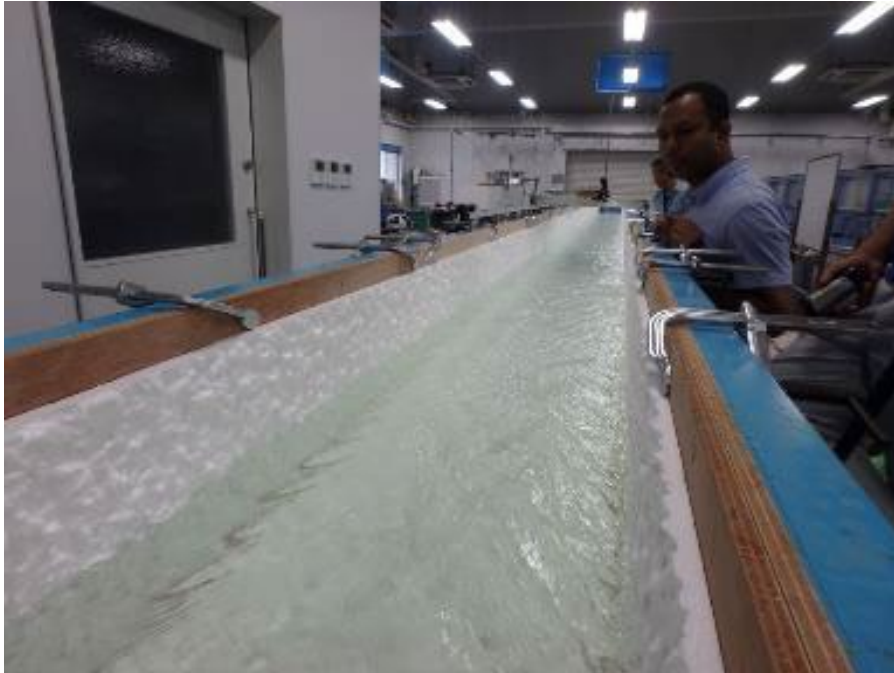
凹凸が規格化されている発泡パネルを用いた水理実験
