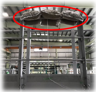
静的載荷試験(手摺/鉛直方向)
