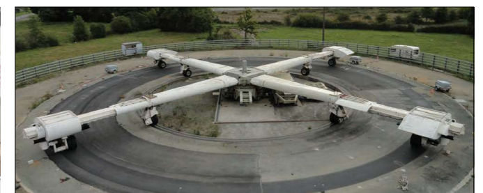
輪荷重走行試験(フランス)
