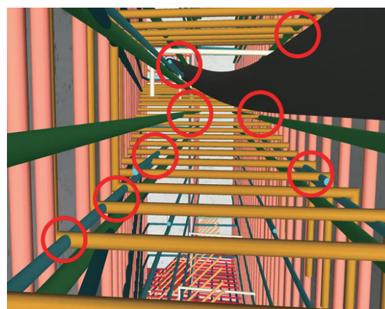
図-2 PC鋼材及び鉄筋干渉チェック
