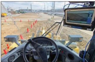
重機の運転席に設置されたPC画面にガイダンスを表示します
