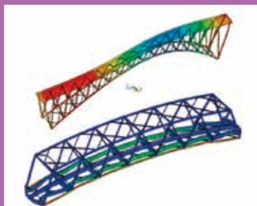
**地盤変動時に生じるアーチ橋およびトラス橋の挙動のデータベース化に向けた数値解析シミュレーション**
