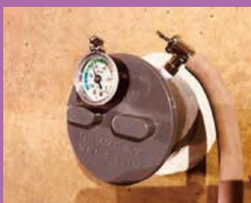
**簡易透気試験器を用いた、コンクリートの表層評価、ひび割れの貫通評価方法を紹介しております。**
