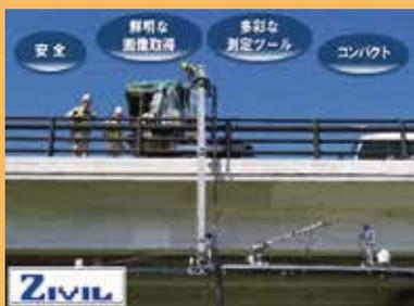
**橋梁点検の際、橋梁点検車が利用できず点検員が近づくことが出来ない橋梁下面の近接目視を支援するロボット**
