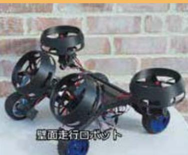
壁面走行ドローンによる打音ソリューション！
