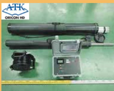
観測孔用に開発した新型流向流速計 (Type-40)
