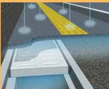
暗渠化工事で側溝上に排水性舗装を施工する際に使用する
