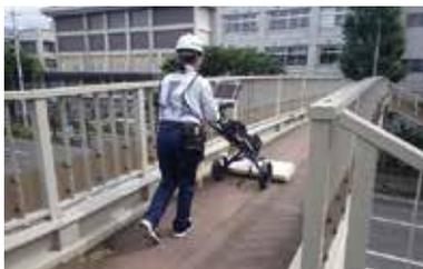
現場での組立・解体が可能なカート式電磁波レーダによってコンクリート床版の内部状況を非破壊で調査する技術です。従来のハンディ式電磁波レーダと同様、劣化診断・異常範囲の判定が可能であることに加え、一度に広範囲（幅1m程度）を計測できるため、現場での時短によるコストの縮減が期待できます。
