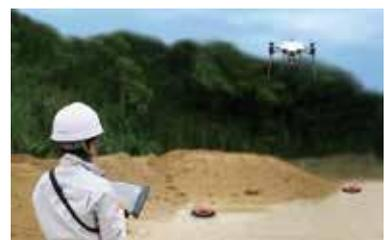
エアロボ測量はドローン測量を経済的で効率的に実施するためのレンタルサービスです。レンタル構成はドローン本体、エアロボマーカ、エアロボクラウドがあり、測量を実施する上で必要となる機器が揃っています。ドローン本体は離発着を含めた完全自立飛行型の機体であり、高解像度カメラを搭載している他、目的に応じて赤外線センサー等、様々な拡張が可能です。エアロボマーカで取得した標定点データとドローンから空撮した画像をクラウドへアップロードするだけで3次元データが完成するため、作業負担を大幅に軽減することが可能です。
