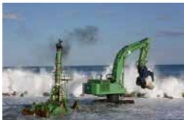
昭和46年以来、1200件以上の実績がある当社独自の工法です。水陸両用ブルドーザ43.5t級(作業水深7m)は、養浜・離岸堤工事等の海岸工事や漁港等の維持浚渫工事、河川改修工事等、また災害復旧工事にも使用され、東日本大震災の被災地各所で稼働しています。
