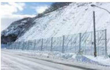
スロープガードフェンスタイプLSは、道路際や民家裏に設置し、「せり出し防止・雪崩予防・雪崩防護」に対応できる鉛直式雪崩対策製品です。支柱基礎が杭構造になっているため、軟弱な地盤に設置することができ、柵高を調整しポケット部を確保するため、スペースが少ない場所にも設置することができます。崩壊土砂防護柵として改良したスロープガードフェンスタイプLEもあり、タイプLS同様に杭基礎構造のため、これまでの待受け型擁壁よりも、適応可能な箇所が拡大しています。
