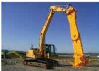
WILL工法は、機動性に富むバックホウタイプベースマシンの先端に取り付けた特殊な専用攪拌翼(リボンスクリュー型攪拌翼)により、深度1.3m程度まで対応可能な中層混合処理工法です。小型機を使用するため、低騒音・低振動な環境面に配慮した工法です。小型機でありながら、掘削補助装置(ブームランププレート)を装着することで軟弱地盤からN値4.0未満の締まった砂質土までの幅広い土質に適用可能です。また、専用管理装置には攪拌翼の軌跡が表示されるナビゲーションシステム搭載され、さらなる品質管理の信頼性向上が図れます。
