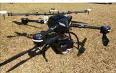
「Sky-i-Scanner1」は、GNSS・IMUにより自機位置を測位し、レーザ計測データと同期することで三次元点群データを取得する機器です。上空40m程度からレーザ計測を行うことができ、災害箇所等の人が踏み入れることができない場所での作業も可能です。
