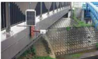
平成28年度に国土交通省水管理・国土保全局が立ち上げた『革新的河川管理プロジェクト』に参画し、以下の特長と機能を有するクラウド型・メンテナンスフリー水位計の開発を行っています。現地試験の結果は良好で、去る1月23日に提示された『危機管理型水位計の観測基準・仕様』に合わせ、現在最終調整を行っています。また、寒冷地対応の開発にも参加しています。
