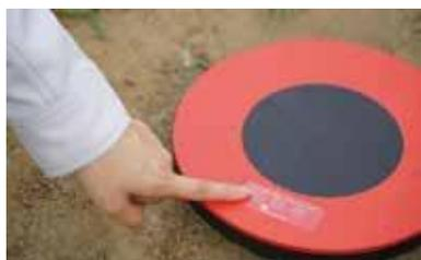
エアロボマーカは日本初のGNSSロガーを搭載した高精度計測のドローン用対空標識です。GNSS測位では最も精度の高い計測手法であるスタティック即位を採用しているため、置くだけで約1cmの精度で計測が可能です。標定点、検証点設置に係る現場作業はエアロボマーカを設置するだけで対応が可能となり、従来のようにトータルステーションなどで別途測量をする必要がなくなります。また、3次元データを作成する際、エアロボクラウドと連携させることで、エアロボマーカの位置をAIで自動認識させることも可能なため、ドローン測量の作業工数を削減することが可能です。
