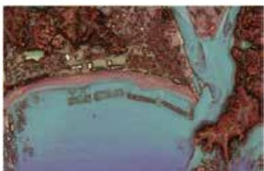
これまでの陸部での計測の主流である近赤外波長を用いた航空レーザでは、レーザ光が水面で吸収されるため、水部は測れませんでしたが、新たに導入したグリーン波長のレーザ光を用いたALBでは、水部も計測でき、防災、環境など全ての面で基礎データとなる水深が取得できます。
