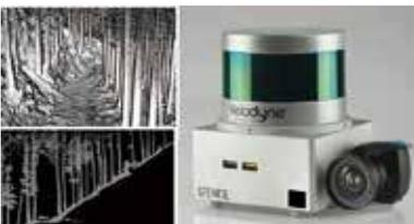
SLAM (Simultaneous Localization and Mapping) とは自分の位置特定と周辺地図の作成を同時に行う技術です。特長はスキャナやカメラなど外部を計測するセンサーのデータを利用できるため、装置がコンパクト、システムも比較的シンプルにできます。GNSSの電波の入らない木陰や屋内、高架線下などでも、リアルタイムに精度5～10cmの三次元点群データの取得が可能です。小型軽量のため計測員が手持ち、あるいは背負いながら歩いて計測します。(車載も可能)
