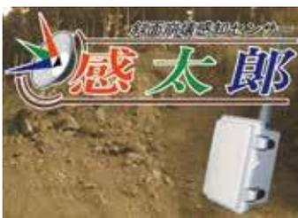
MEMSの活用により、安価・小型・軽量・省電力・設置簡単、且つ高い測定精度を実現した斜面崩壊感知センサー(商品名:「感太郎」)を開発しました。崩壊に伴うセンサー自体の転倒により崩壊を自動検知します。また、刻々と変動する地表面の変動角度を経時的に測定することによって、斜面の安定性の変化や崩壊前兆の把握に活用できるセンサーです。急傾斜地や地すべりの計測、被災斜面の二次災害監視、山留め施工、落石、構造物の変状監視などに様々な場面でご利用いただけます。また、双方向自動遠隔監視システム「観測王」と組み合わせることで、迅速な情報提供や警報発信などを行い、防災・減災活動に役立てることが可能になります。
