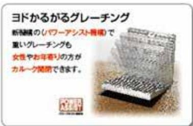
グレーチング本体を閉じた時にトーションバーがねじられ、開ける時はその反発力がアシスト力になるパワーアシスト機構付きの開閉型グレーチングです。グレーチングの寸法と重量に対応したトーションバーの本数と線径を選択して、最適なアシスト力を設定しています。投雪を行う流雪溝、農業用水路の止水板の上など、頻繁に開閉するグレーチングに最適です。1万回以上の繰返しテストをクリアしていますので、安心して御使用いただけます。
