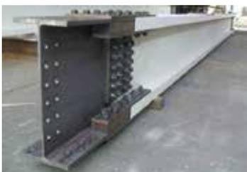
SZパイルは、シールドマシンで切削可能なH形GFRP製土留材です。主に柱列式土留壁の鏡部芯材にセットすることにより、シールドマシンの直接発進到達を可能にします。施工性に優れ、比重が1.8のためソイルモルタル中で自沈し、隣接するオーガ削孔も支障ありません。また腹起し用ブラケットも取付可能です。
