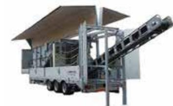
「STB-MC工法」は現場で製造した発塵抑制型湿潤化セメント系固化材を用いた浅層地盤改良工法です。
