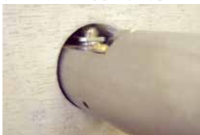
局部載荷試験状況の例
