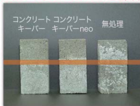
オレンジ色の線まで高温度塩水に浸したコンクリート
