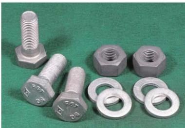
過去より高力ボルトの表面処理と言えば、溶融亜鉛めっきが主流でしたが、耐食性能をアップしたSGめっきで表面処理をすることにより、沿岸地域や融雪剤を使用する塩害環境下では溶融亜鉛めっきに比較して2~5倍以上の耐食性能を発揮する事が出来ます。「神鋼SGめっき高力ボルト」は平成24年3月24日付で、建築基準法第37条に基づく国土交通大臣認定(認定番号 MBLT-0102)を取得しました。
