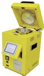
「W/Cミータ [MT-300]」は、フレッシュコンクリートから採取したモルタル試料の水分量を「減圧式加熱乾燥法」により現場で直接測定することができる単位水量測定器です。測定は本体のタッチパネルにデータを入力するだけでモルタル試料の計測から乾燥作業まで全て自動化されているため、簡便かつ短時間で精度の高い測定値を得ることができ、測定単位水量は勿論、推定水セメント比と推定強度を同時に見ることが出来ます。
