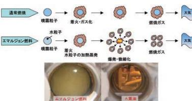
加熱アスファルト混合物を製造するアスファルトプラントでは、骨材の乾燥・加熱に必要な高温熱風を化石燃料の燃焼により得ています。燃料燃焼による温室効果ガス排出量を低減させる対策として、水と油を混合して得られるエマルジョン燃料を製造・燃焼することにより二酸化炭素(CO<sub>2</sub>)や、酸性雨や光化学スモッグの原因となる窒素酸化物(NOx)、硫黄酸化物(SOx)の排出が低減できます。また、エマルジョン燃料を使用したアスファルト混合物は、従来の燃料を使用した場合と同程度の品質を保ちます。
