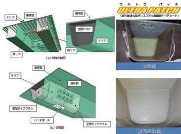
高耐久性鋼床版用樹脂製密閉ダイアフラム工法
