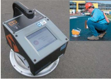
**測定面より電磁波を出し、設定した舗装厚さの密度を瞬時に測定。路面温度が高い状態でも測定可能。従来のコア抜きによる密度管理を補完する画期的な測定器。**
