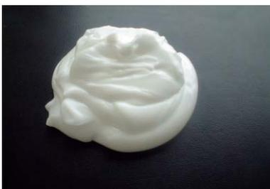
「マジカルリペラー」は、コンクリート表面にシリコン樹脂の吸水防止層を形成して、コンクリート内部への水や劣化因子の浸透を防止する材料です。塩害・凍害・アルカリ骨材反応などの劣化進行を遅らせて、コンクリート構造物の耐久性を向上させます。新設構造物の予防保全対策及び補修した構造物の再劣化防止対策のいずれにも適用することができます。
