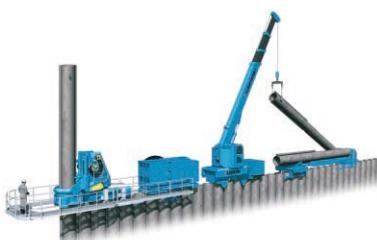
杭の「搬送」「吊込み」「圧入」の全作業を、杭上の限られたスペースだけで行う圧入施工技術です。水辺離陸地、傾斜・不整地、狭隘地、低空頭地など困難な現場条件でも、仮設栈橋や迂回道路などの仮設工事が不要で、本来の目的である壁体構築を合理的に行います。
