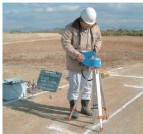
簡易支持力測定器「キャスポル」は、加速度計を内蔵したランマーを地盤に落下させ、そのランマーが地盤に衝突する際に得られる衝撃加速度の最大値から構造物などの基礎地盤の支持力計算に必要な強度定数を計算します。本装置一台で、 $K_{30}$ 、 $q_c$ 、CBR、 $c$ 、 $\phi$ の測定が可能ですので、施工管理に大きく役立ちます。操作が単純・簡単に個人誤差が抑制でき、地盤の支持力特性値などをリアルタイムに評価できる。反力が不要なので狭い場所や山間部でも適用できる。ランマーを落下させるだけで試験時間が短いので試験結果を直ちに施工管理に反映でき、省力化できるので試験費用が廉価である。
