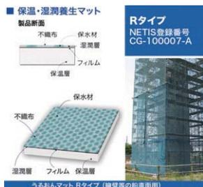
湿潤養生と保温養生を同時に行い高品質のコンクリート構造物を構築することを目的とした湿潤養生層と保温層を有する二層構造マットです。一体構造となっているので敷設は一回で行えます。又、転用回数は10回程度可能です。散水回数を低減できますのでアルカリ汚濁水の流出を最小限に抑え環境にやさしい製品です。この度、Sタイプについて平成25年度活用促進技術に指定していただきました。
