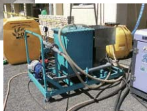
沈殿汚泥濾過装置
