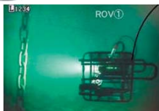
係留装置の水中撮影状況
