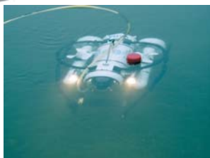
水中探査装置の作業状況
