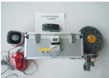
徐行誘導支援装置は、道路上の通行規制区間への車両進入に対して、徐行誘導員に代わって運転ドライバー及び、作業関係者に警報・警告を「視覚・聴覚」により徐行と注意を促す装置です。車両を検知するセンサーと、徐行案内、徐行警報音等を作動させる為の制御ユニットボックスまでの所定の距離には、受送信機を使いコードレス化しました。車両を検知するセンサーは現場で設置できる可搬式、各電源は12Vバッテリー式、装置全体（オプション保安用品を除く）で8kgと軽いので、片手で持ち運び出来、いつでもどこでも設置できます。
