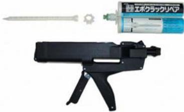
舗装路面のひび割れを簡易に補修復旧できるエポキシ系充填材です。材料はノンタールで環境に配慮、硬化が早く作業性と接着強度に優れています。カートリッジに充填した2液性エポキシ樹脂を混合ミキサーで攪拌しながら吐出し連続した充填が、だれにでも簡単にできます。
