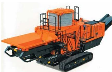
新世代エンジン（3次規制）を搭載して新登場。さまざまな性状をもつ原料土を効率よく、高品質に改良する混合効率の高い「2軸パドルミキサ」を採用。「振動ゲート」の採用とあいまって粘性土・高含水比土質でも安定した原料供給を可能にしました。
