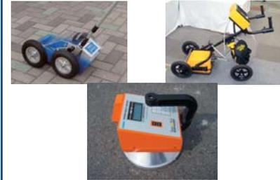
『PQI 301』は、放射線を使用せずにアスファルト舗装面の密度を測定する装置です。動力源は送信機と受信機を使用し電磁波域を作り出し (トロイダル電場) 使用します。周波数はラジオのAM・FMの幅です。測定も舗装面に置いてボタンを押すだけで3秒間で密度、空隙、表面温度表面湿度を測定します。安定した品質の管理に適しています。特に床盤上の舗装や管工事後の補修工事等にも最適です。この他、地中管の存在を電磁波で調べる装置 (地中埋設管探査装置) や歩道の滑り具合を調べる「すべり抵抗測定器」も展示します。
