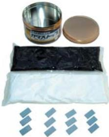
マンホールの蓋が輪荷重等により偏磨耗し、鉄蓋がガタツキ、騒音が発生した場合従来は、くさび等を挿入して応急補修していました。しかし「ガタストップ」はスペーサー（調整板）を受枠に設置し、樹脂で蓋と受枠の隙間を完全に埋めるため騒音が瞬時に止まります。樹脂はエポキシ樹脂系接着剤で耐久性、接着性、作業性に優れており簡単に補修ができます。
