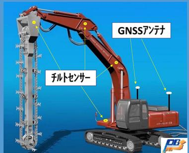
**中層混合処理工でのICT施工**
