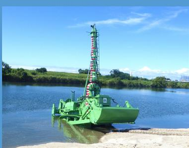
**陸上機械や作業船では施工が困難な浅瀬域で仮設工事も少ない効率的な水中掘削機械**
