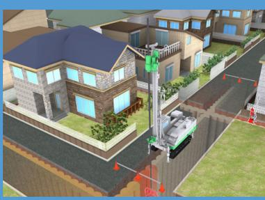
**住まいながら宅地境界を地盤改良壁で囲む液状化対策工法**
