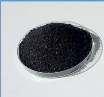
バイオ炭を用いてCO<sub>2</sub>を固定する環境配慮型アスファルト舗装
