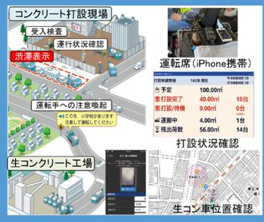
**GNSSを用いた工事車両運行管理システム**
