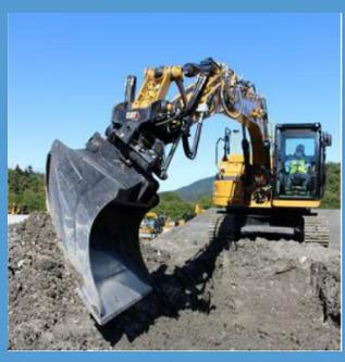
**左右のチルトに加え360° 旋回により 圧倒的な施工の自由度を提供**
