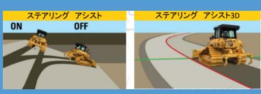
2D / 3Dで利用可能なシステムです。2Dでは走向直進性を維持し、3Dでは設定したガイドライン上をステアリングアシストすることで正確に走行できます。特に2Dではブレードに負荷がかかった状態での走向直進性に効果があり、経験の浅いオペレータのスキル不足を劇的に改善できます。走行の自動制御によりステアリング操作が不要となり、オペレータの疲労軽減、ステアリング精度向上にお役立て頂けます。
