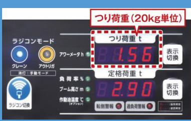
**正確なつり荷重の常時見える化を実現したデジタル式荷重計**
