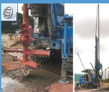
**噴射と攪拌による大口径改良体の造成を可能にした深層混合処理工法**
