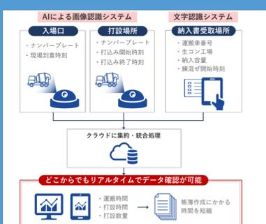
**AIを用いたコンクリート打設監視システム
