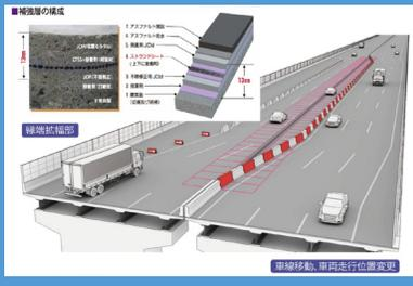
**床版上面の急速施工型補強工法**
