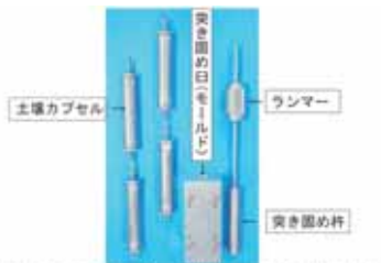
土壌浄化モニタリングカプセル及び突き固め密度調整器
