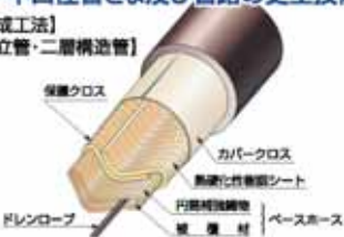
パルテムSZ工法 更生管の構造図
