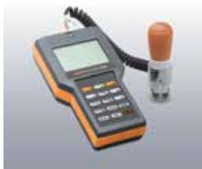
道路橋コンクリート床版の防水施工の際は、床版表面の水分管理が防水層の性能ひいては道路橋の性能を左右する重要な要素となります。しかしながら床版表面の水分測定の際、表面処理後の凹凸面の影響を受け、測定値が低くなる場合があります。本器「HI-100」は凹凸面の影響を減らすべく、測定原理に電気抵抗式を採用し、導体ゴム製のゴムセンサを備えました。これにより、凹凸面にゴムセンサが密着し、正確な測定が可能です。なお、本器は(一社)日本建設機械施工協会施工技術総合研究所との共同開発製品です。
