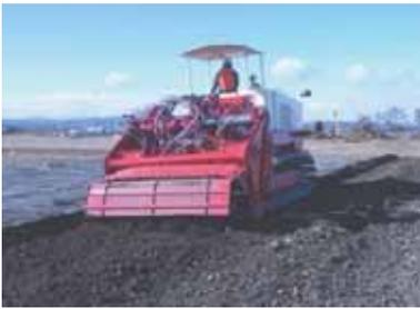
「S T B工法」は軟弱地盤や軟弱土質の土質改良に混合精度が良いスタビライザを用いて改良する「浅層地盤改良工法」です。最大深度1.2mまで混合可能です。主にセメント系や石灰系の固化材を用いる化学的固結改良工法と、単独では利用できない建設発生土を粒度改良によって改善した上で築堤盛土材として再利用する河川プランケット工事等の物理的改良工法があります。また昨今問題視されている有害物質の封じ込め等、幅広く利用できる工法です。東日本大震災復興復旧工事には多くの現場で採用いただいております。
