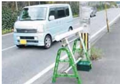
**軽量で機動性に優れ、設置・操作が簡単な交通量計測機器
