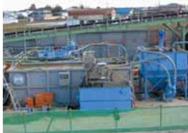
**鉄粉剤を用いた吸着・分離除去システムにより自然由来の重金属等を含有したシールド泥水を浄化する技術**
