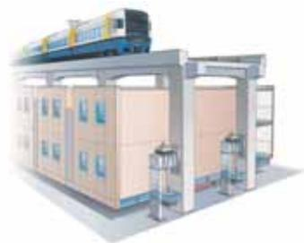
鉄道・高速道路などの高架下や高架上空には、大きな可能性を秘めた未利用空間が眠っています。「吊り免振工法」は、高架下空間で建物を吊り構造にし、その免震効果で安全性を高めると同時に、吊り材に配された防振ゴムで列車振動を低減し、静粛な室内空間を実現する技術です。実施例として、鉄道高架下でホテルを実現した事例があり、列車通過時でも室内は極めて低い騒音レベルに抑えられていることを確認しています。展示では本技術のほか、高架上・高架下で魅力的な施設を実現するための構造安全性や防振性を確保する技術をご紹介します。
