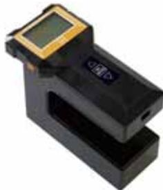
本体とセンサ部を一体化したハンディタイプの高周波容量式の水分計です。対象物に軽く押し当てただけで、片手で確実・簡単にすばやく水分が表示されます。従来器「HI-520」に比べ画面サイズは大きくなり、新たにバックライトを搭載しました。また測定対象にコンクリート、モルタル、ALC、人工軽量骨材コンクリート、石膏ボードに加え、新たにケイ酸カルシウムボードを新搭載しました。
