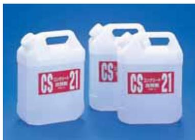
CS-21は無色透明・無臭の無機質水溶液で、硬化後のコンクリート表面に塗布することでひび割れ深部を含む表層部の空隙を緻密化し、施工後新たに発生する微細ひび割れ等の空隙も充填する性能により、水および各種劣化因子の侵入を長期にわたり抑制します。かぶりコンクリートを健全に保ち、橋梁等の構造物において凍害・塩害・中性化等による鋼材腐食を抑制する長寿命化対策、あるいは地下および水槽等の躯体防水が可能です。これらは施工10年以上経過した複数実績の追跡調査により効果持続性が確認されています。その他打継ぎ処理材として、または漏水箇所の止水材あるいはひび割れ補修の際の注入材としても適用可能です。
