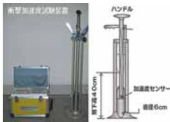
「衝撃加速度試験装置」は、盛土の品質管理を簡単・迅速・安価に行うことができる試験装置です。砂置換法・R1法による盛土の品質管理方法では、結果の判明まで1日以上時間を要していたため、工事の進捗に影響が生じておりました。
