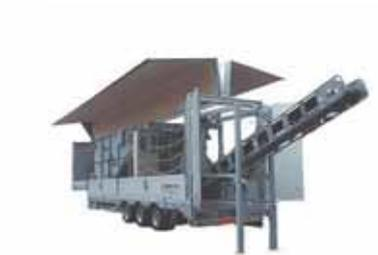
「S T B-MC工法」は現場で製造した発塵抑制型湿潤化セメント系固化材を用いた浅層地盤改良工法です。
