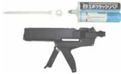
舗装路面のひび割れを簡易に補修できるエポキシ系充填材です。材料はノンタールで環境に配慮、硬化が早く作業性と接着強度に優れています。カートリッジに充填された2液性エポキシ樹脂をミキシングノズルで攪拌混合しながら吐出し、連続した充填がどなたにでも簡単に行えます。
