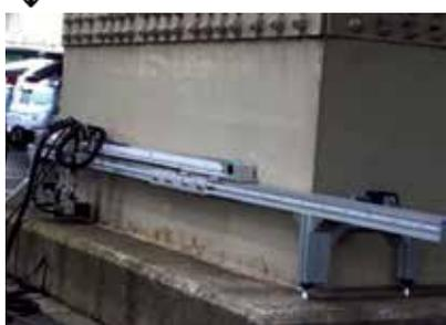
鋼製橋脚の基部では、腐食の進行性が極めて速いマクロセル腐食により著しく部材断面を欠損させます。この鋼部材がコンクリートに埋設された目視困難箇所をの損傷を検査するには、根巻きコンクリートのはつり作業や塗膜の除去などの煩雑な作業を要します。本技術は、非接触の渦流探傷センサーと板厚減少量の推定手法を用いることで、根巻きコンクリートや鋼材塗膜を除去することなく、目視困難箇所の残存板厚を測定することが可能です。また、この非破壊測定データを用いることで、腐食劣化診断や健全度評価を行うことができ、定期的な測定により残存寿命の予測も行うことができます。
