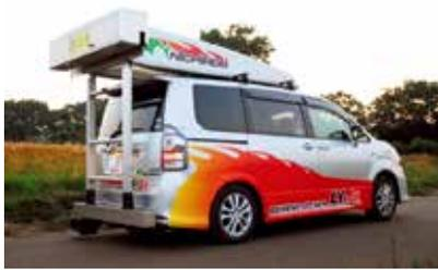
道路舗装の総点検に必要なデータを交通規制なしで、取得可能な調査車です
