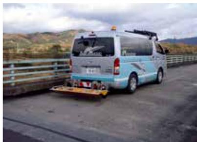
**橋梁の床版上面やアスコン層の損傷(土砂化など)やアスコンの厚さなどを非破壊で調査できます**
