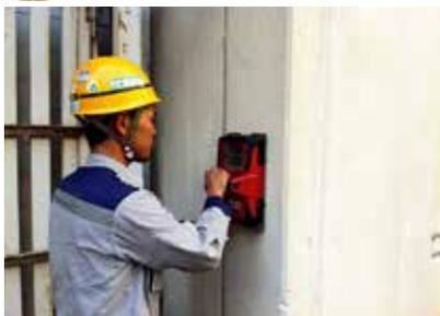
コンクリート構造物内の様々な埋設物(鉄筋・銅・アルミニウム・プラスチックパイプ等)を電磁波レーダーにて探査し、埋設物の有無や鉄筋のかぶり厚さ等、詳細な解析をスピーディに実現します。また、探査の結果に基づき、弊社工事部との連携で墨出しも行いますので、探査から墨出しまでムダのない一貫作業による効率化が図れます。
