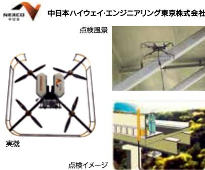
**リモコンヘリを用いた構造物点検システムです**
