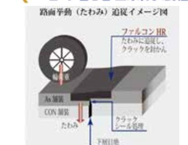
「舗装の長寿命化を図るクラック抑制工法」
