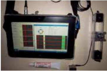
**超音波測定装置を活用した、非破壊試験による標識柱・照明柱の地際部腐食・健全度状況診断装置**
