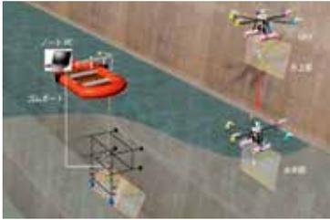
**多視点画像3D構築技術によるダム水上・水中点検システム**
