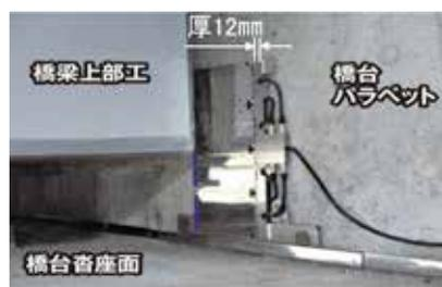
スキマミルは、橋梁の桁端面と橋台との数センチの隙間を見ることができるカメラ装置です。
