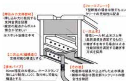
東北地方の鋼道路橋の桁端部では、伸縮装置の止水材が脱落し、塩分を含んだ漏水が主桁に流れ込み、著しい腐食による孔食や座屈などの損傷が橋梁定期点検で確認されています。今回出展する検討は、伸縮装置に作用する『押し込み力』に着目し、積雪寒冷地域の伸縮装置（鋼製の楕円フェースプレートで荷重を支持する製作ジョイント及び製品ジョイント）に求められる要求性能について取りまとめたものであり、現在、復興道路・復興支援道などで試行を開始しています。
