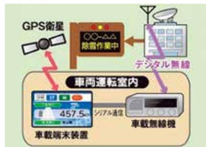
GPS車両位置管理システムは、安定したNEXCOデジタル無線技術と的確なGPS信号による車両位置情報を活用し、高速道路の作業車が今どこで何を行っているのかをタイムリーかつ正確に把握することができます。
