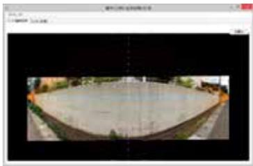
コンクリート面のクラックや亀甲ひび割れの補修に先立ち、従来は現場でチョーキングを行い、図面へのスケッチとCADを使つての作図作業を行う必要があった。本製品を使うことにより、スマートフォン (iPhone) でのパノラマ写真撮影、PCへの取り込みと画像変換、画像のトレース作業へと作業の簡便化が可能となる。
