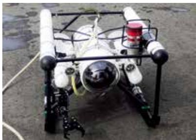
管理する水門・堰・ダム・橋脚等の現状を把握し、異常及び損傷を早期に発見するために配備されており、遠隔操作で水深140mまで潜ることができます。装置には、照明付きのカメラを装備しており、濁度10ppm程度まで鮮明な水中映像をリアルタイムで地上のモニターで確認、録画することができます。また、マニピュレータと呼ばれるロボットアームが装備されており、小型の対象物の回収や撮影対象の簡易な清掃が可能です。
