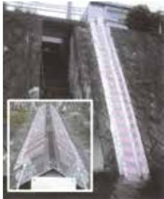
**「新開発の立体型量水標」 設置側河岸からの視認性が良好な為、急激な増水時でも、対岸に移動する時間と危険を回避できる(特許製品)**
