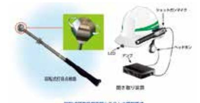
「コロコロ eye」は多面体が回転した際に発生する打撃音の変化から、コンクリート内部の異常箇所を発見する打音点検器です。
