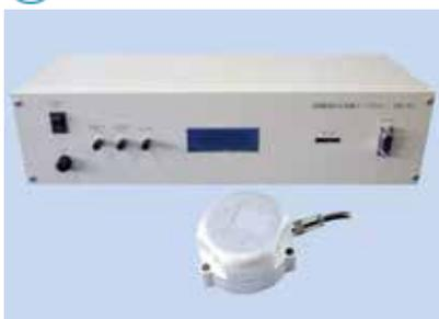
**砂防堰堤などの無人地域において、省電力で地震観測・データ記録を行う地震震度計**
