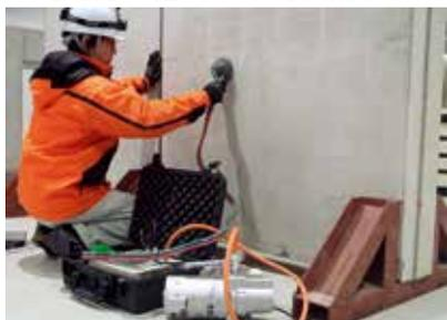
東北地方におけるコンクリート構造物は、凍結融解の繰り返しによる凍害や凍結抑制剤による塩害など、水に起因する損傷が多く見られます。これらの損傷を出来るだけ抑制するためには、施工段階におけるコンクリートの表層品質の確保が重要です。今回出展する機器は、表層の品質を定量的に評価するために透気係数や吸水量を測定する機器であり、コンクリート構造物の耐久性向上、長寿命化に資する事を目的として、復興道路・復興支援道路等で使用しています。
