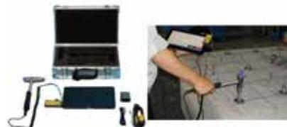
**ボルト・ナットの健全性検査装置**
