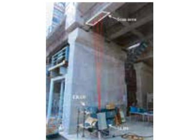
**音加振による叩き点検、非接触・長距離の探査(足場不要)、振動分析による評価(経験・個人差なし)**
