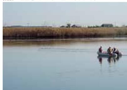
リモコンボートは無人の調査船であり、河川・ダム・湖沼・海岸・港湾等の水域部について、安全に低コストで深淺測量を行うシステムです。DGPSと音響測深機を小型リモコンボート内に搭載し、陸上の安全な場所から遠隔操作にて行います。
