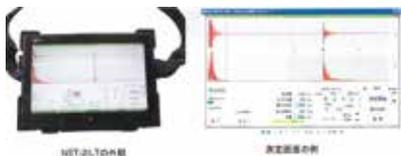
**非破壊試験による鋼製防護柵・アンカーボルト・鋼矢板等の埋設部根入れ深さの測定装置**
