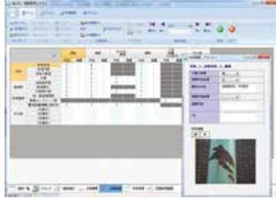
道路附属物／歩道橋／舗装／土工構造物(法面・盛土・擁壁等)の膨大なデータ管理と、各構造物の点検業務を支援します(H25総点検要領およびH26点検要領の両方に対応)。
