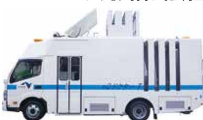
**トンネル覆工画像とひび割れ自動抽出により、近接目視点検を「より早く」「より確かで」「より安全に」支援します。**
