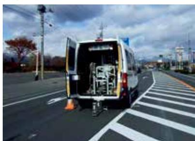
**道路舗装の構造評価を、非破壊で実施する調査車です。**
