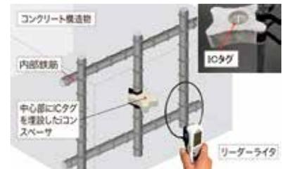
**ICタグを内蔵したスペーサを用い、かぶり厚の検査や目視点検による結果等の情報を管理するシステムです。**
