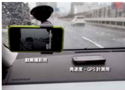
iPhoneまたは車載型センサユニットを用いて、舗装の路面性状をIRI(国際ラフネス指数)で評価するシステムです。特徴として、簡易な取付方法(車内に機器を設置)で車のパネ上でのIRI計測が可能なこと、iPhoneの持つ機能(加速度・角速度センサ、GPS、動画、画像、音声)を活用していることがあげられます。また、本システムは東京大学、京都大学、長崎大学、長岡技術科学大学、当社等が参画するコンソーシアムを通じて、システムの高度化検討・開発及び国内外への展開を図っています。
