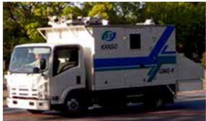
**高精度GPSと空洞調査をコンバインドした新しい堤防下探査診断システム**
