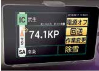
**雪氷作業の的確な管理と検測作業の効率化を図る車両位置情報システム**
