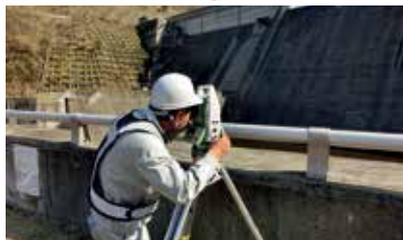
**コンクリート構造物等ひび割れ調査において、離れた場所から迅速・高精度での調査を可能とした計測システム**
