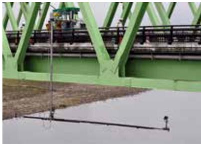
**橋梁点検車が利用できない橋梁点検の近接目視を補完する技術で、次世代社会インフラ用ロボット現場検証応募技術。**
