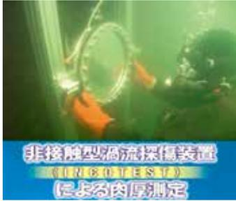
非接触型の渦流探傷装置 (INCOTEST) を使って、港湾や漁港の鋼構造物の肉厚測定を行い、施設の維持管理計画を策定します。INCOTESTは、従来の超音波による肉厚測定と比較して、以下のメリットがあります。
