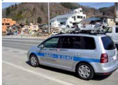
**車載型移動計測システム(MMS:モービルマッピングシステム)**
