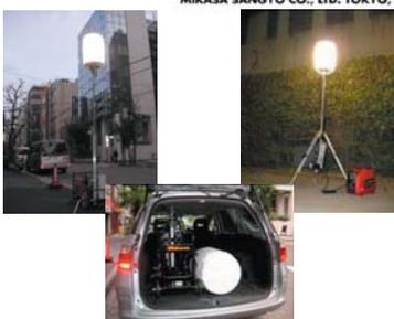
従来のバルーン型投光器などに比べ、投光部は円筒形で、工事車両等で引っ掛けたりする心配が少ない形状になっており、送風・冷却用ファンが不要なため、静粛性、風に対する安定性に優れています。ランプは100V(700W)ですから、一般家庭用電源または0.9KW以上のインバーター式発電機で使用可能です。ランプカバーには耐紫外線、引き裂き強度に優れたセイルシート(帆)をしようしております。また、交換する際の着脱もファスナー式で容易に行うことができます。
