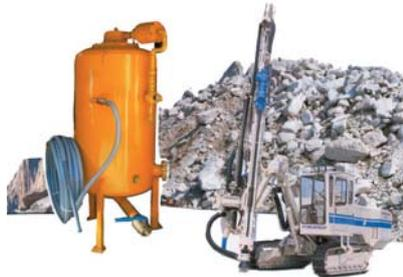
本装置は「AN-FO」の発破孔中の残水回収水抜き装置です。サク岩機のコンプレッサーよりエアーを供給するだけで、レシーバータンク内を真空とします。発破孔に吸引ホースを挿入し吸引開始コックを開くと発破孔より残水を吸引回収します。
