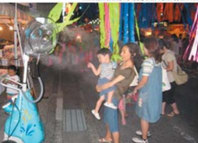
霧状にした水をノズルから放出し、蒸発に伴う気化熱で周辺温度を下げることでより涼しさを提供致します。夏の猛暑を緩和し、体感温度を2～4℃下げることができ、消費電力はスポットエアコンの1/2以下(CO<sub>2</sub>排出量も50%軽減)、熱交換による放熱も無い環境に優しい省エネ設計です。また、水が粉砕する時に発生するマイナスイオンにより、周辺環境の改善効果も期待できます。更に、製造工場に於ける粉塵対策や園芸作業、静電気防止のための加湿対策にも使用できます。
