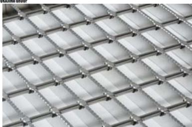
従来の組工式グレーチングとは違い圧接式に加工することにより、メインバーとクロスバーの圧接構造で、メインバーの独立強度を迫りました。(改行)今まで対応できなかった耐荷重T-25も可能になりました。(改行)特に車輛の通行する環境や駐車場の出入口、またフォークリフトが頻繁に横行する工場・市場などに最適です。
