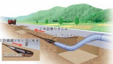
ドリルヘッドに内蔵されたビーコンからの信号を地上で探知しながら方向修正を行い計画線上を削削し、到達坑より発進坑側に非開削にて埋設管を引き込む工法です。
