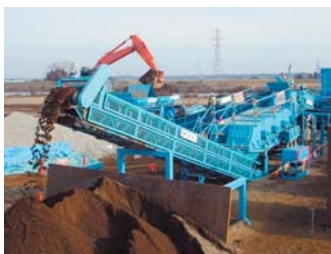
万能土質改良機による建設発生土再利用システム
